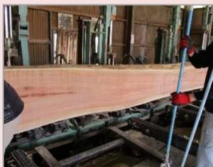
真樺(マカバ)の丸太を厚み60mmに製材しました。幅600mm以上、長さ4000mm以上がとれる国産材は大変貴重です。
