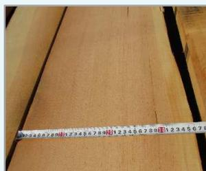
米松ピーラー材を製材しました。多少、節やヤニつぼがありますが、建築材として十分使用できます。
